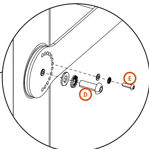
3. Avvitare la vite M10 centrale **D** (con le sue rondelle) e avvitare la vite M5 **E** (con le sue rondelle) per scegliere l'angolo di inclinazione.
