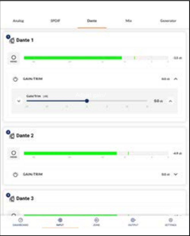
Diagram 6D Dante® Input display
