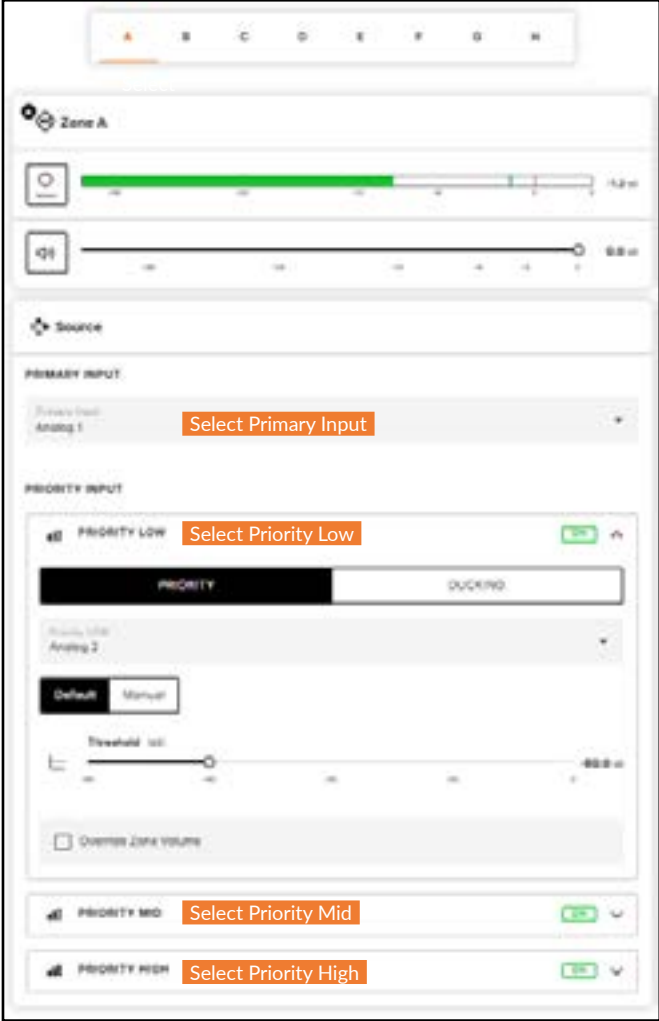
Diagram 6G Zone Source menu display
